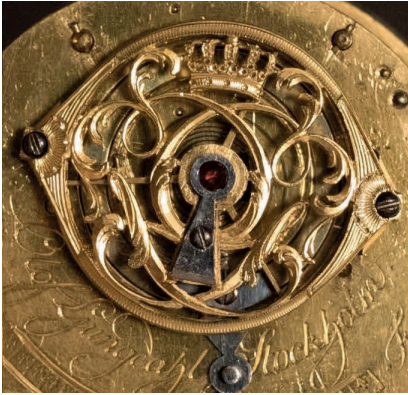
De två vanligaste varianterna av kungliga kronor på balansbryggan i Liungdahls fickur. Foton: Urban Windahl.
