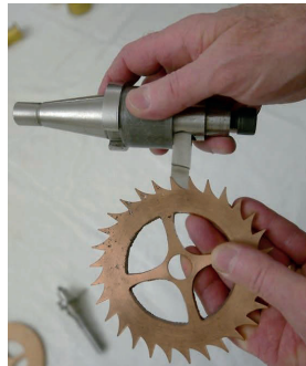
Gånghjul och fräs till stalluret.
