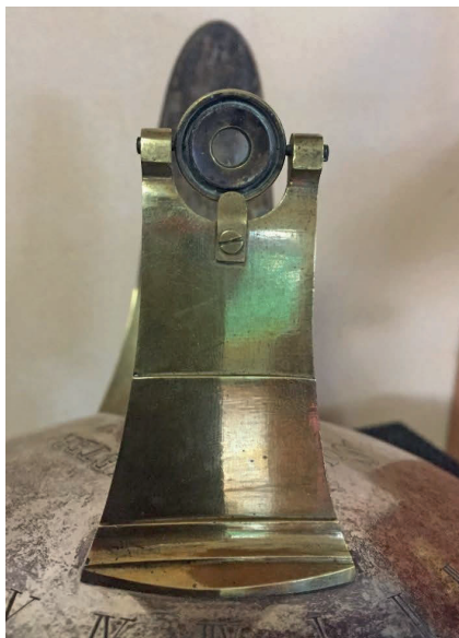
Sollinsen som skall riktas mot solen då lokal tid skall avläsas.
