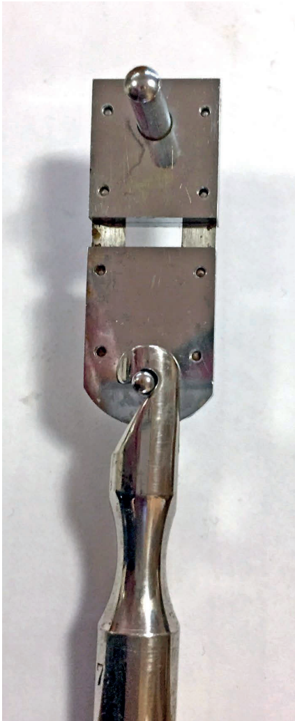
Upphängning med pendelfjäder från Riefler.
