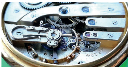
Kronometer 48294, närbild på balanspartiet.
