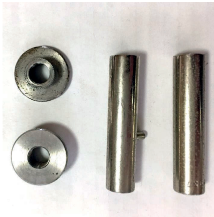
Juster- och låsmutter av invar och kompensationsrör, röret i mitten med styrstiftet är av mäsning det andra av stål.
