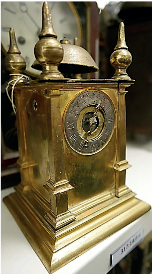
Osignerat, dubbelsidigt bordsur, ombyggt från balans till pendelgång ca 1580-1600 (x).
