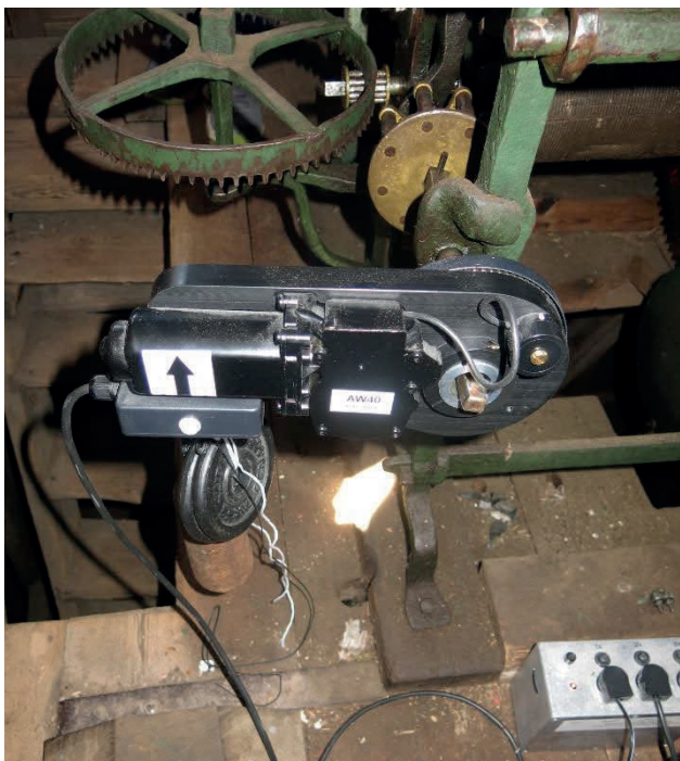
Autowinder monterad på uppdragsaxeln för gångverket. Foto E. Read 2019
