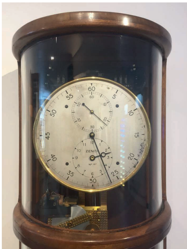
Zenith sekundpendelur, uppdraget synligt under urtavlan.
