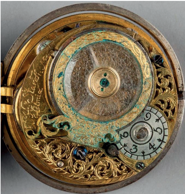
Fickur David Starck Holmia, ca 1720. Balansbryggan med glas är ärgad (x)(xx).
