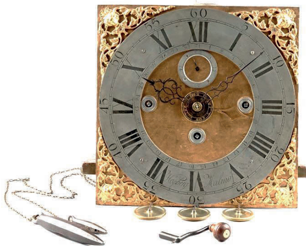
Lars Jacobsson Högborg, f 1738–d 1798, kom som gesäll från Ystad till Malmö 1773. Golvursverket med hög detaljkvalitet har tim- och kvartslag, datum, sekundvisare samt väckning(x)(xx).
